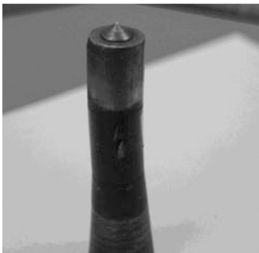
شکل ۵. پیچیدگی سنبه پس از پانچ ۵۰۰ سوراخ به دلیل سختی پایین.
