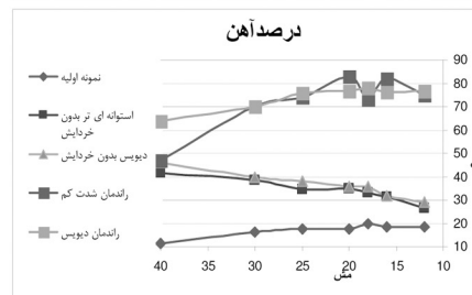
شکل ۱. مقادیر آهن و اکسید آهن در کنسانتره نمونه بدون خردایش و نمونه خرد شده در لوله دیویس و جدا کننده.
